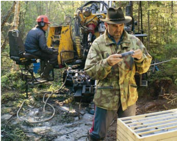
Geologi tutkii kairanäytettä, takana kairauskone. Valokuva: Jari Väättäinen, GTK
